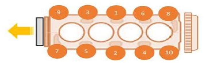
Nota: Substitua todos os parafusos do cabeçote, dos mancais principais e mancais de biela
