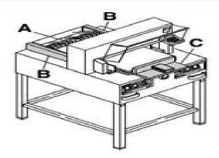
Установите бумагу к задижну упору (А) и боковым упорам слежа или справа (В. Для перемещения столы бумаги испольтуйте поставляемый сталкиватель (С). Двиганте задиний упор вперед, чтобы подвиганте, столу бумаги).
