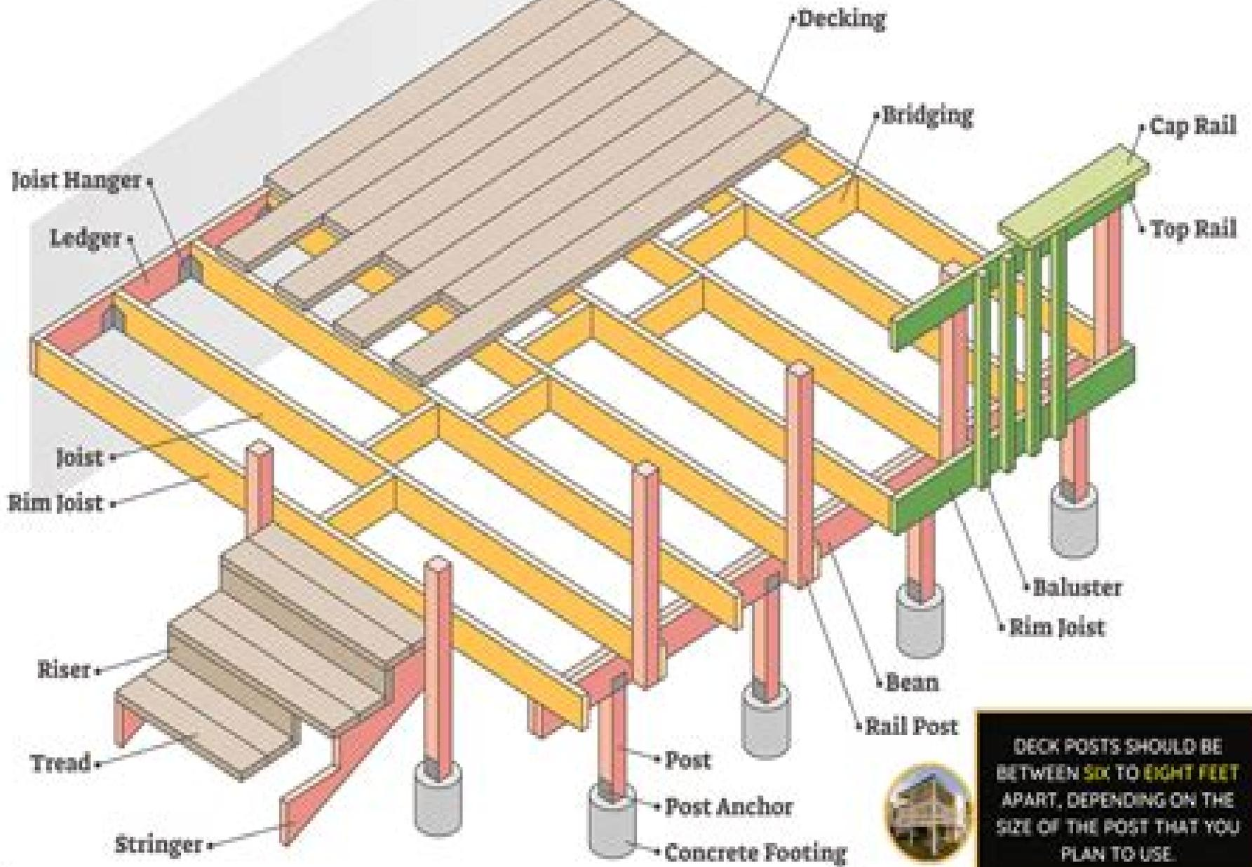
DECK POSTS SHOULD BE BETWEEN **SIX TO EIGHT FEET** APART, DEPENDING ON THE SIZE OF THE POST THAT YOU PLAN TO USE.
